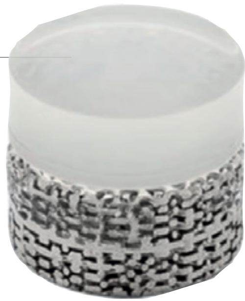
Figura 5: Implante de SynACART®. Se aprecia la base de titanio poroso y la superficie lisa de policarbonato uretano.
