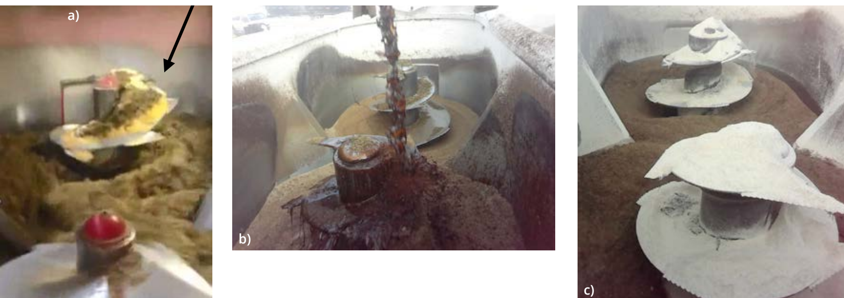
Figura 3. Fotografías de raciones en preparación en el que los MM (incluidos en un premix en polvo, granulado o en las melazas) no se han mezclado homogéneamente
