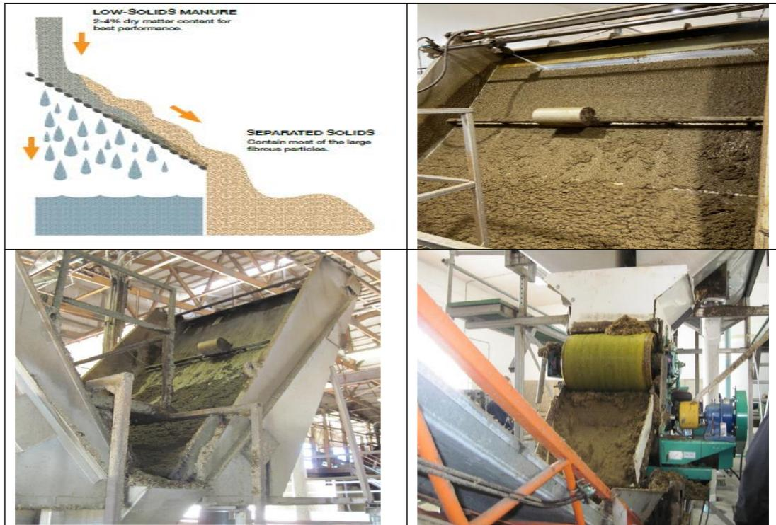
Motor generador. Compresor de gases, separa impurezas para la combustión y mide la cantidad de metano que se genera para cuantificar los bonos de carbono que se comercializan. Separador de excretas solidas de tornillo. Separador por centrifugación. Figura con coladera inclinada. Coladera de excretas inclinada. Coladera inclinada en V. Coladera con rodillo aplanador.
