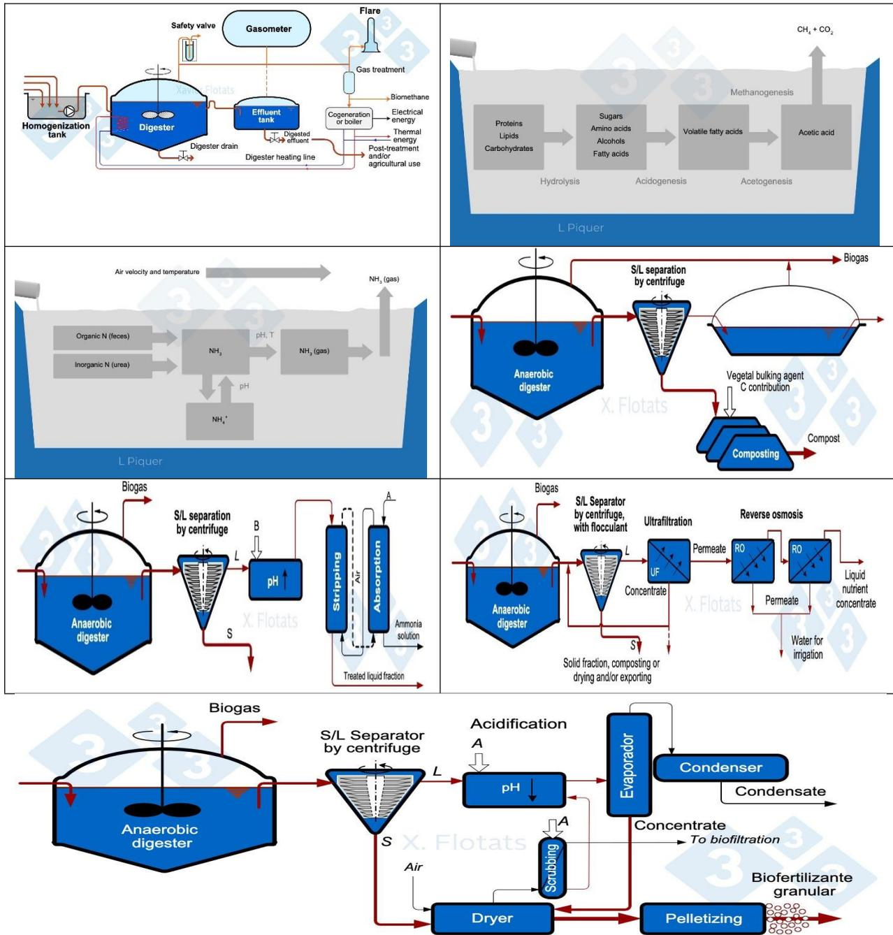
Flujo del proceso de excretas hasta obtener electricidad. Reacciones químicas metanogénicas en el biorreactor. Liberación de  $\text{NH}_3$  de un biodigestor abierto. Proceso combinado de composta orgánica y producción de  $\text{CH}_4$ . Tratamiento para separar fertilizante nitrogenado y agua limpia. Procesado de subproductos separados por membrana. Fertilizante granular comprimido o pellet.
