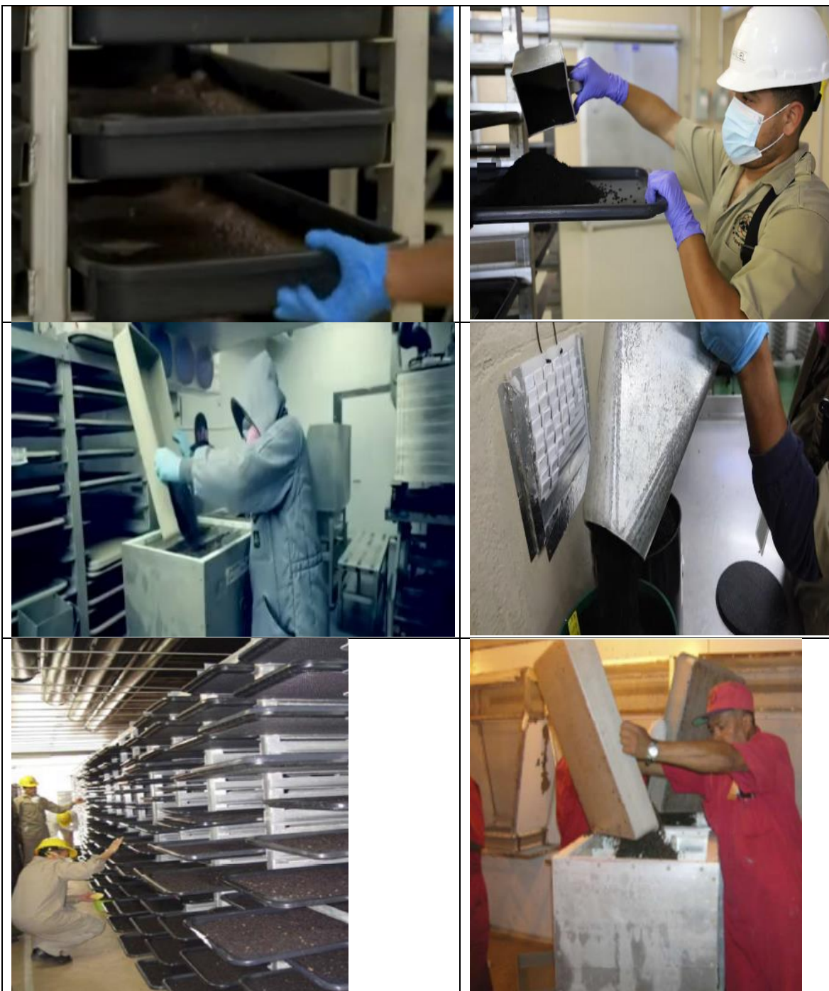
Las charolas de pupas se acondicionan para preparar las cargas que se introducen en el aparato de irradiación.
