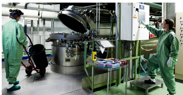
Profesionales del IRTA-CReSA utilizando el digestor que permite eliminar las muestras de tejidos o de material sólido, garantizando la inactivación total de los microorganismos que pudieran estar presentes.
